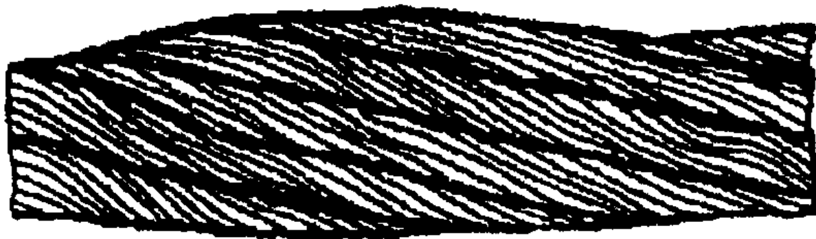
Рисунок 13. Местное увеличение диаметра каната.
