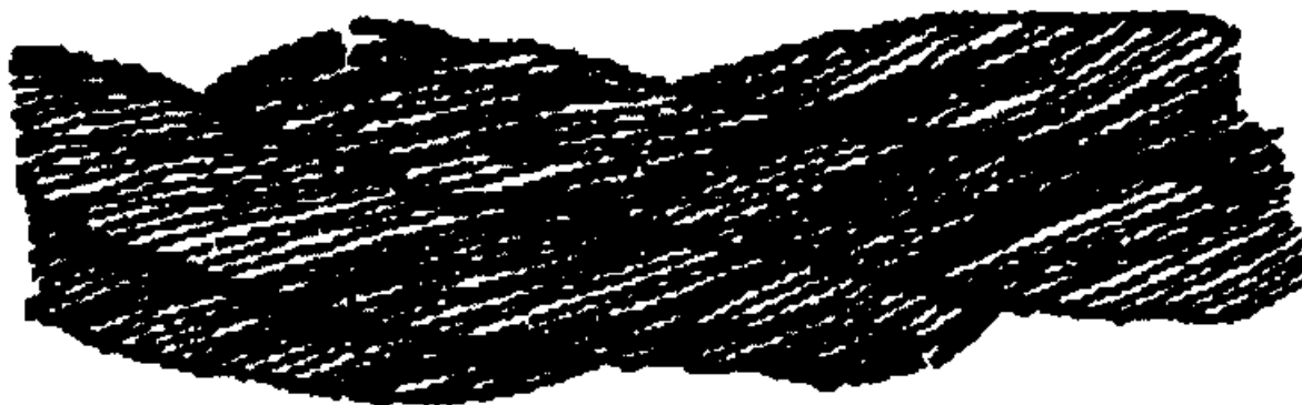
Рисунок 1. Обрывы и смещения проволок каната крестовой свивки.
